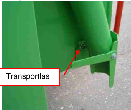
Fig 4.4.1 Afgangsrør lagt ned, transportlås
